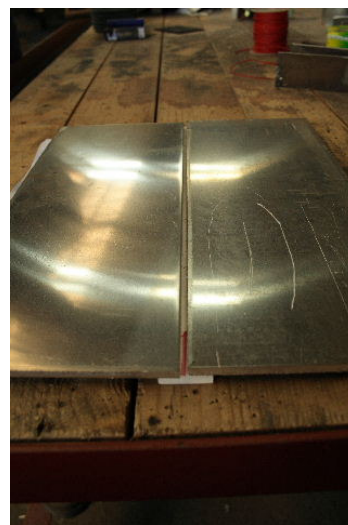
Slika 3a i 3 b. Keramička podloga GULLCO 1G43 AR zaljepljena na aluminijsku atestnu ploču
