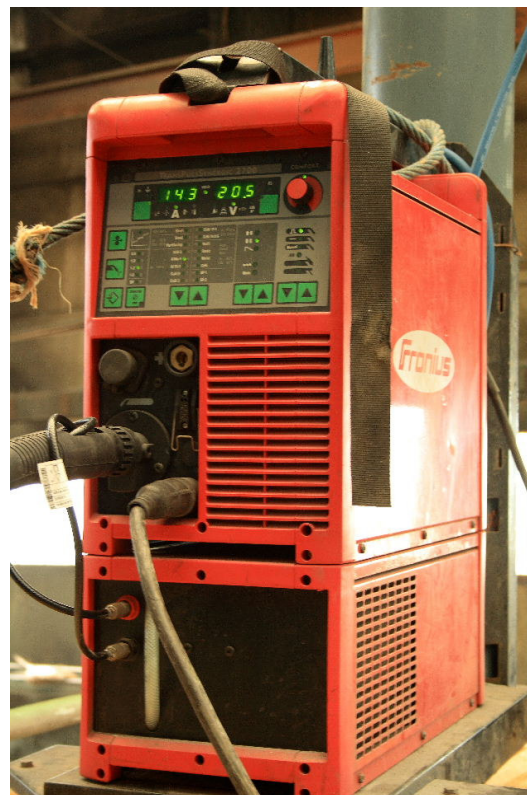
Slika 5b. Stroj Fronius TPS 2700 na kojem je izvedena atestacija
