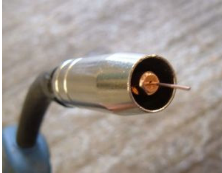
Slika 11. Promjer kontaktne vodilice mora biti nešto veći od uobičajenog
