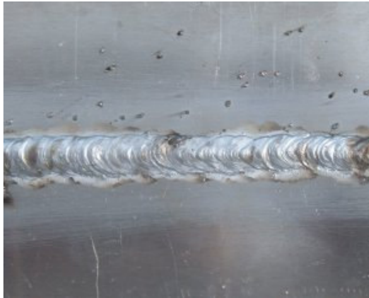
Slika 12. Napokon, zavar za prolaznu ocjenu
