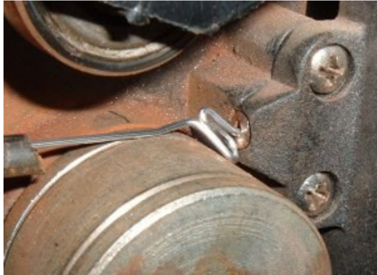
Slika 9. Pritisak valjaka je prevelik, ili imamo pogrešnu vodilicu
