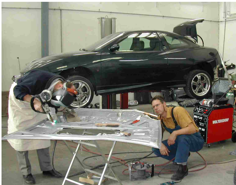
Slika 6. Reparatura aluminijskog dijela automobila
