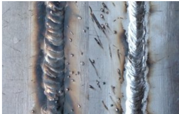
Slika 8. Kod lijevog zavora, smjer zavarivanja je pogrešan (crn zavar)
