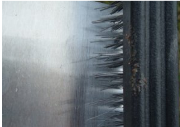
Slika 7. Mjesto zavora treba očistiti
