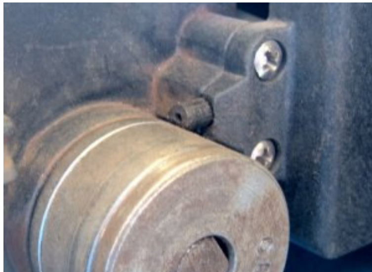
Slika 10. Ulaz žice mora biti kroz teflonsku vodilicu
