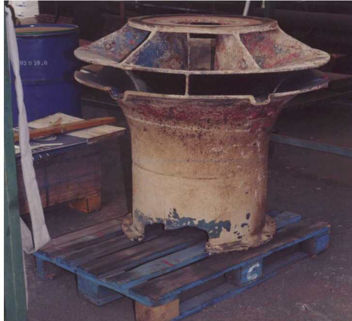
Slika 4. Oštećenja cilindričnog dijela aeratora
