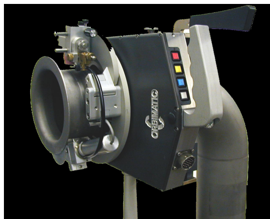
Slika 4. Otvorena glava bez AVC kontrole
