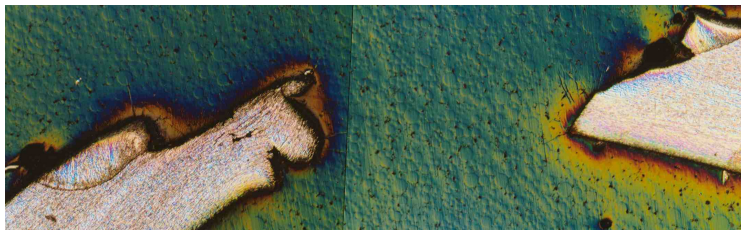
Slika 8: Makrostrukturni snimak u potpunosti razorenog područja zavarenog spoja izazvanog korozijom u procjepu, čelik AISI 316L, morska voda, nekoliko mjeseci, šavni zavareni spoj na cijevi (lijevo), prikaz mehanizma oštećivanja (desno).
