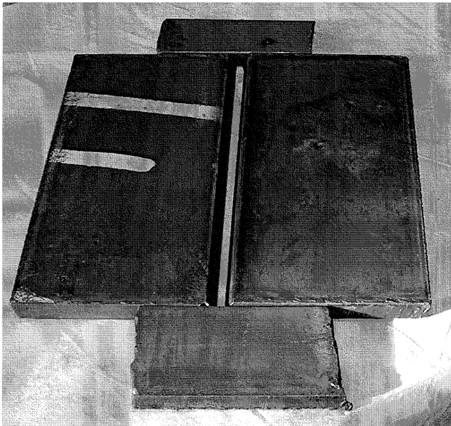
Slika 7. Atestni uzorak za sučeljeni spoj prije zavarivanja
